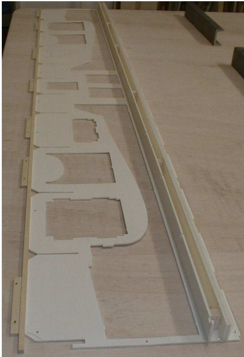
Bild: Flächenhelling mit positionierten Hauptholm ( 6 x 6 mm Kiefernleiste ) auf dem sich die Rippen aufsetzen.
