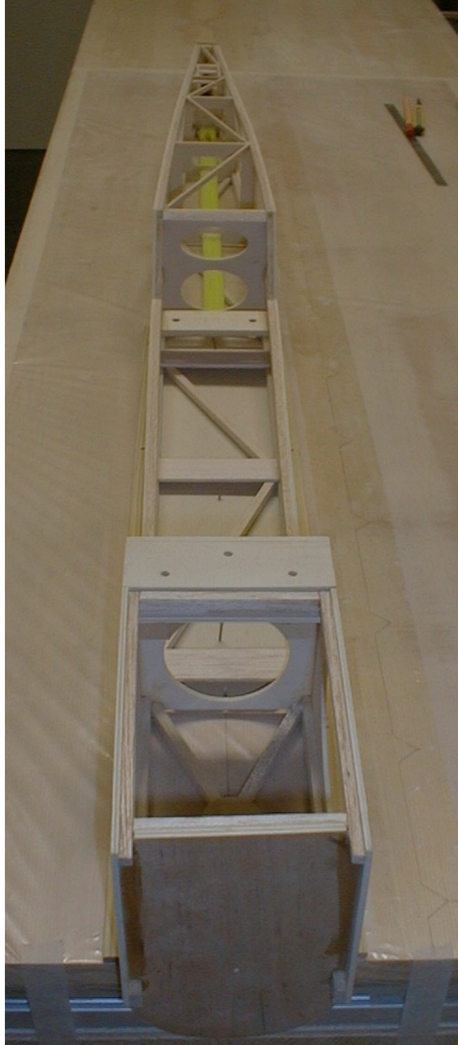
Bild: Rumpf in Helling ; die oberen Diagonalverstrebungen werden natürlich erst eingebaut wenn der Rumpf aus der Helling entnommen ist.
