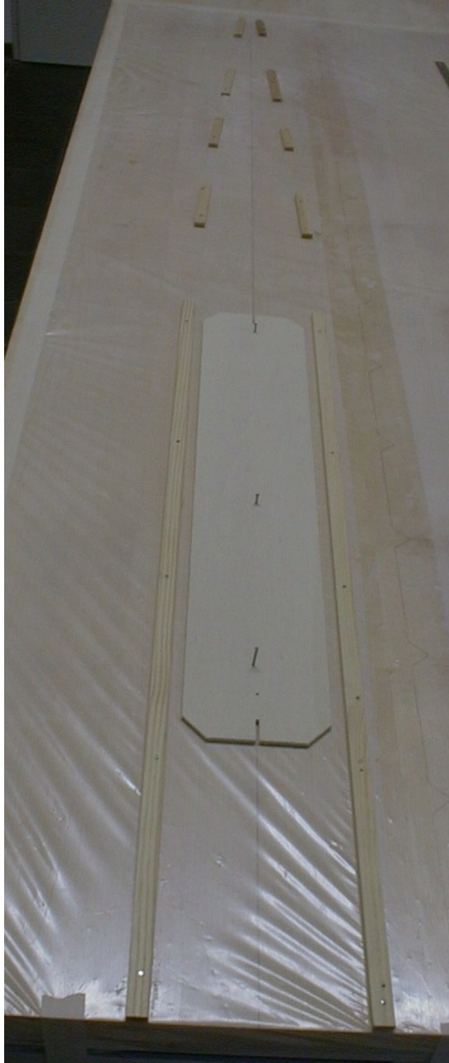
Bild: Rumpfhelling ( Hilfsleisten nicht im Bausatz enthalten )
