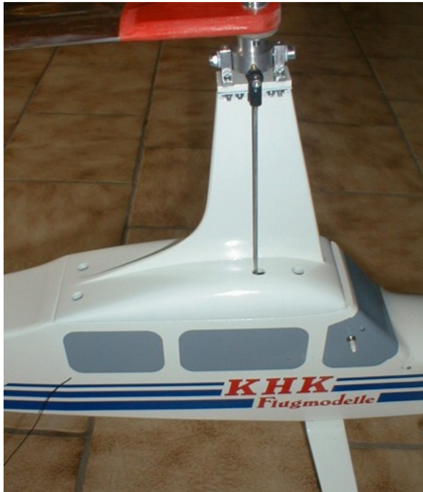
Fertiger Pylon mit aufmontierter Kopf-Kipp-Steuerung ( Rotorblätter nach hinten zum Transport gefaltet )
