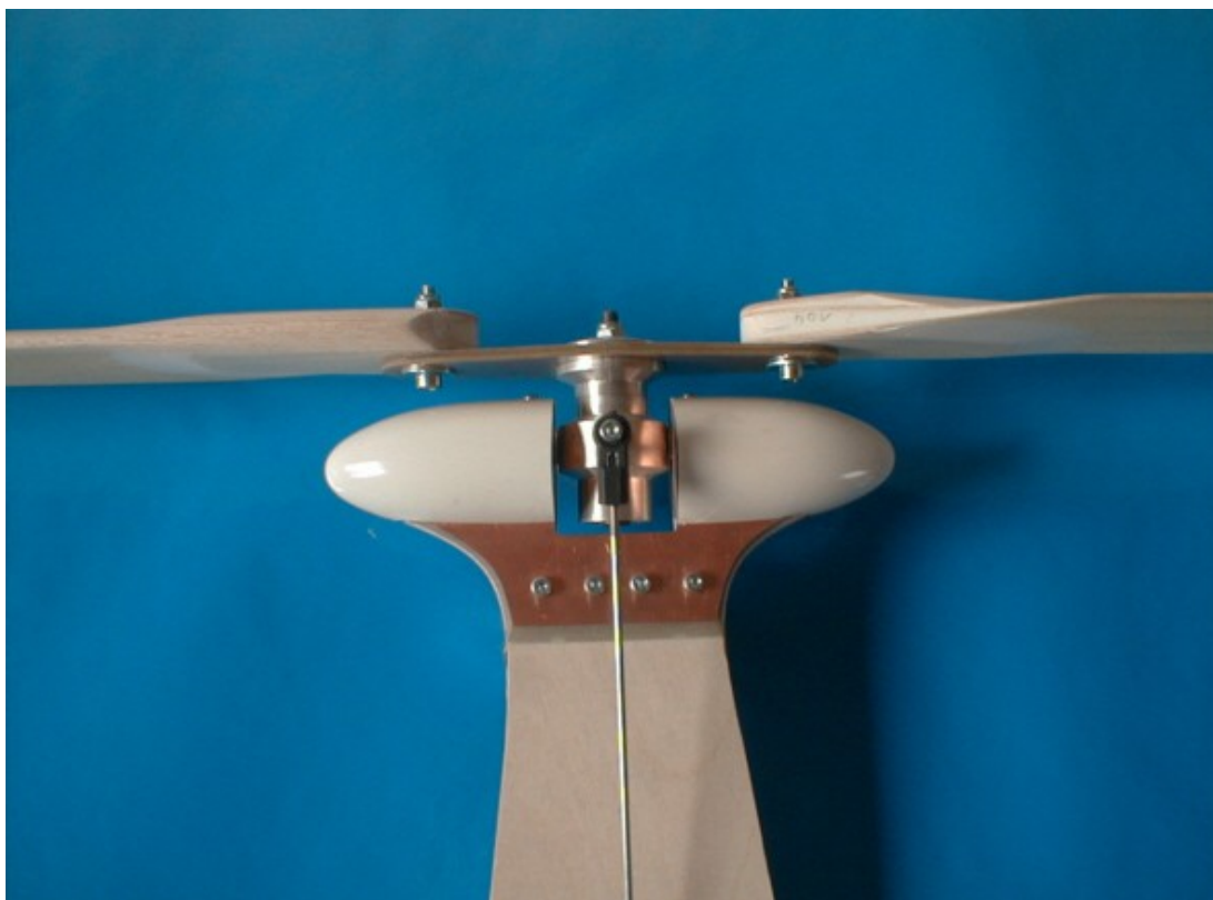
Pylon mit GFK-Verkleidungen
